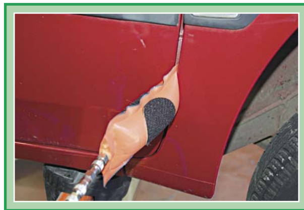
Placement du vérin
