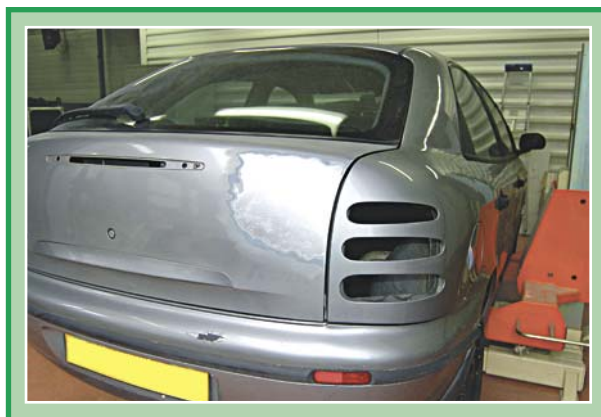
Finition poncée avant mastic
