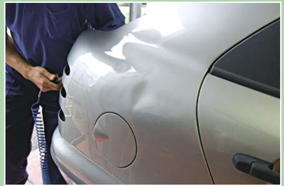
Redressage par l'action du vérin
