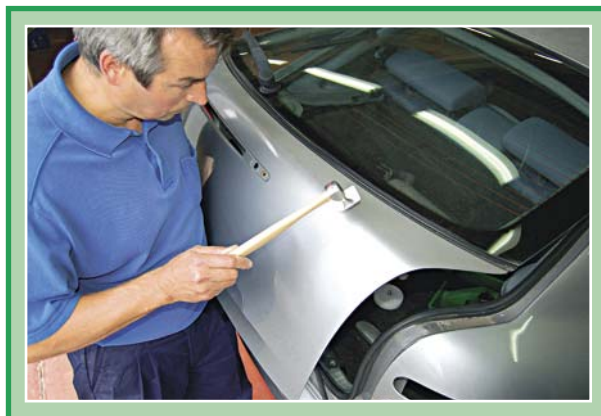
Redressage à l'aide des battes de planage
