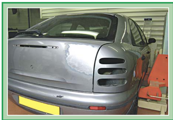
Finition poncée avant mastic
