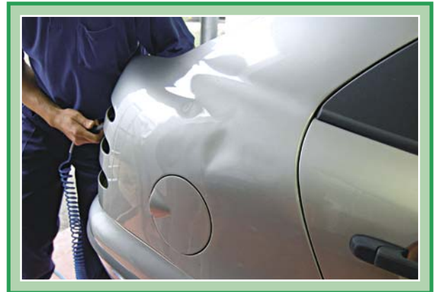
Redressage par l'action du vérin
