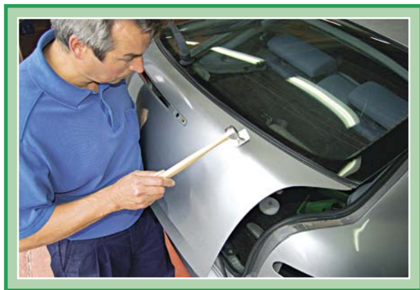
Redressage à l'aide des bannes de planage
